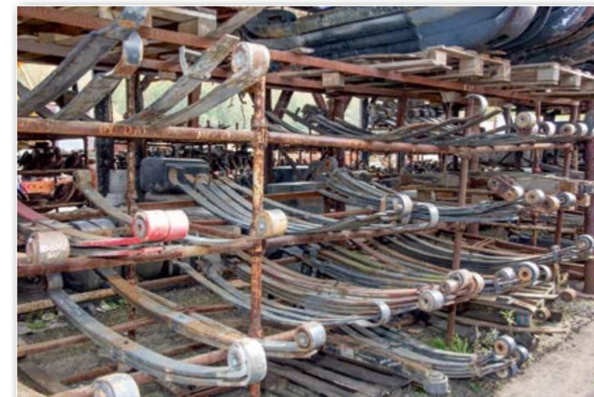
При покупке рессор и полуруссор важно убедиться в отсутствии у них деформации и трещин
