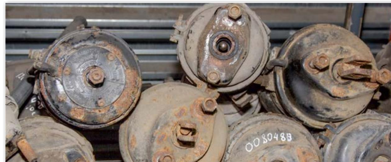
Агрегаты привода тормозов (в частности, пневмокамеры) нужно покупать с осторожностью
