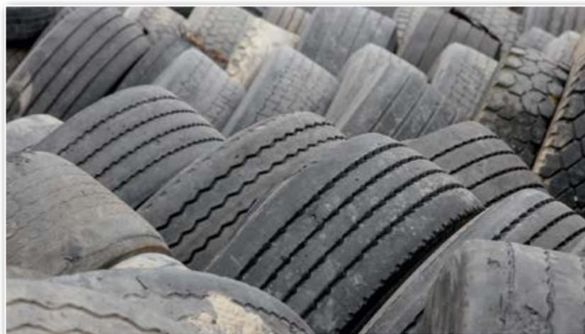
Качественные шины имеют крепкие каркасы, что позволяет после износа их протектора восстановить его холодным или горячим способом и дать шине вторую жизнь. Это значительно снизит стоимость километра пробега шин и сэкономит средства автопарка
