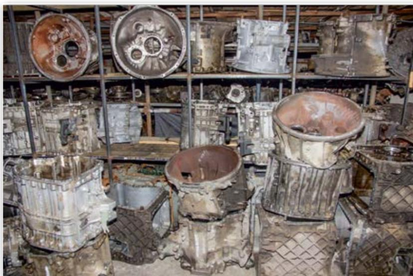
Корпусные детали коробок передач востребованы не меньше блоков цилиндров ДВС
