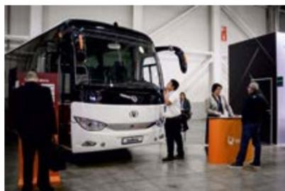
9,1 куб. м. Конструкция кузова и использование современных материалов обеспечивают модели низкую снаряженную массу в классе туристических автобусов, составляющую 13,4 т. Это минимизирует возможность перегрузки автобуса при его полной загрузке.
