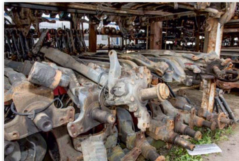
Балки мостов выгодно брать с поворотными кулаками. Нередко даже не требуется менять подшипники, что значительно снижает стоимость ремонта
