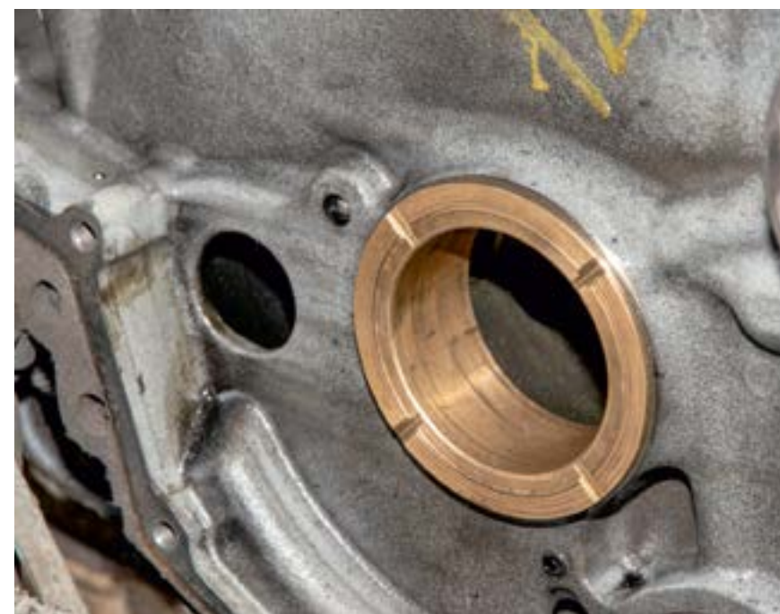
Обязательно оцените состояние втулок распредвала в блоке цилиндров. Они не должны иметь следов критического износа и задиров. При их замене используйте только качественные запчасти
