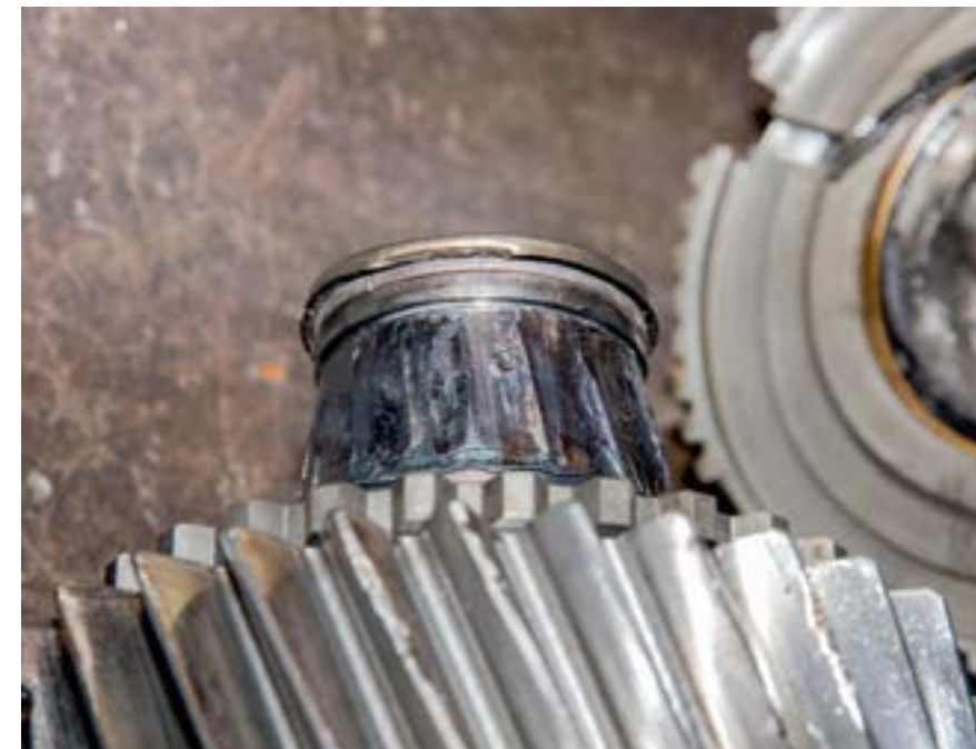
Сильно поврежденный носок вала, на котором был установлен разрушившийся подшипник, – приговор дорогостоящей детали в утиль
