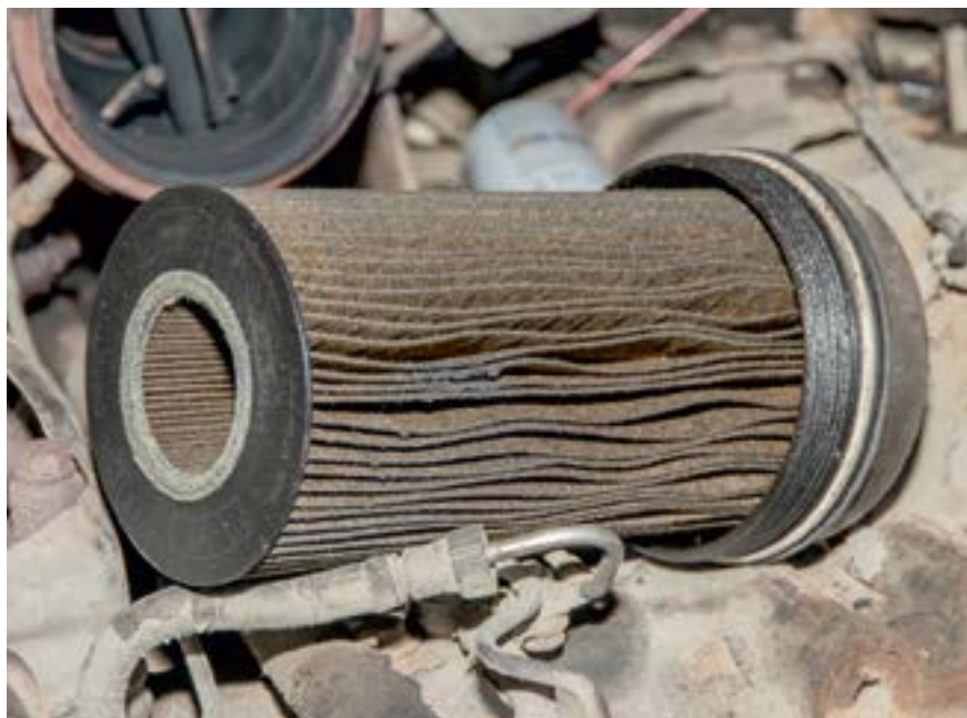
Если в масляном фильтре была обнаружена стружка – ищите ее источник
