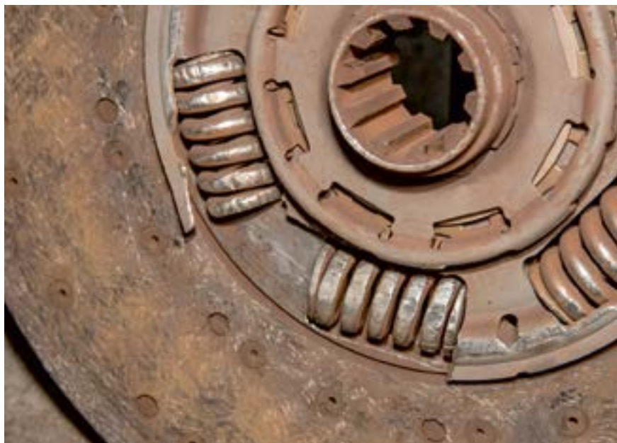
Разрушенные демпферные пружины ведомого диска говорят о работе сцепления в жестких условиях
