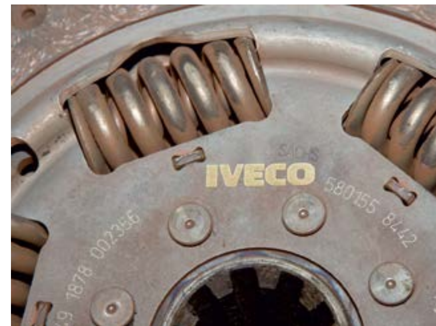
Оригинальные сцепления для тягачей изготавливают лидеры отрасли. Это находит отражение в маркировке и облегчает подбор узла взамен изношенного
