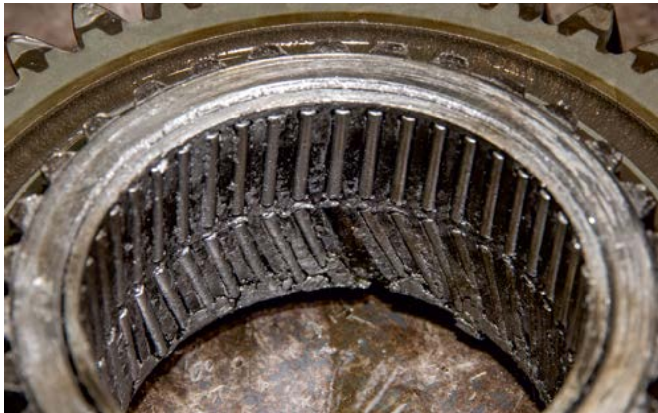
Роликовые подшипники, на которых вращаются шестерни вторичного вала, вышли из строя из-за недостаточной смазки. Условия их работы были очень жесткими, о чем говорит сильное смещение от нормального положения
