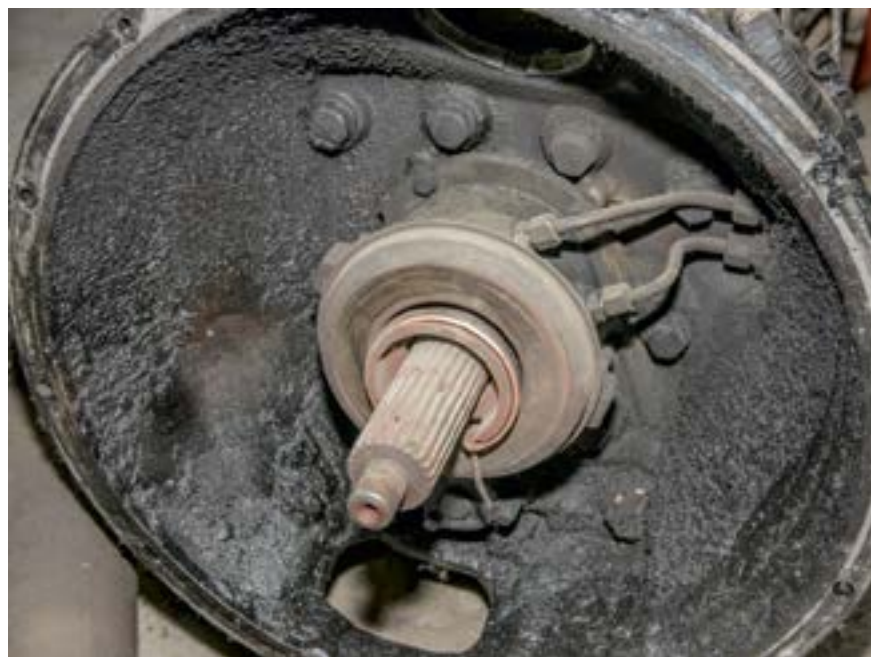
Перед монтажом сцепления нужно проверить техническое состояние шлицов первичного вала коробки передач и механизма привода сцепления. На шлицы тонким слоем наносится консистентная смазка. Если нанести ее много, то излишки под действием центробежных сил попадут на фрикционные накладки и сцепление будет пробуксовывать
