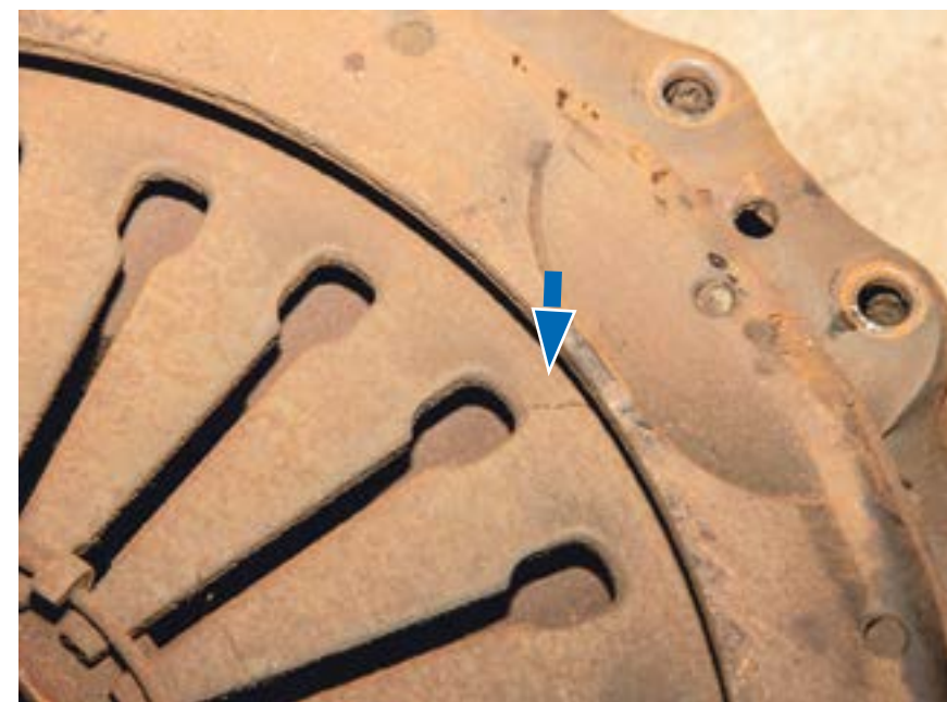
Трещины диафрагменной пружины нередко возникают на сцеплениях невысокого качества, которые продаются под малоизвестными брендами из Азии, или когда узел сцепления длительное время работает с нагрузками, превышающими расчетные
