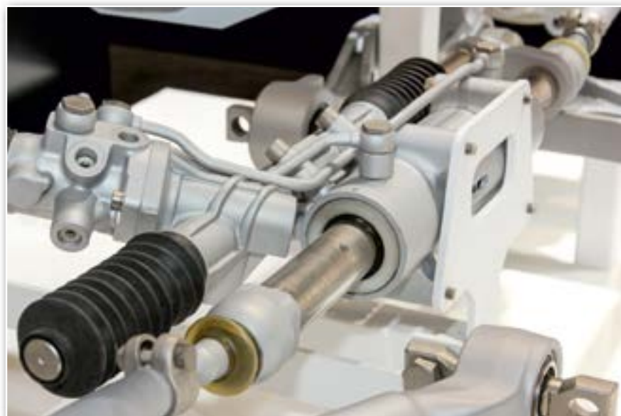
От качества и состояния гидравлической жидкости зависит ресурс и надежность работы агрегатов привода рулевого механизма
