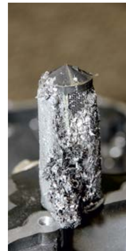
Наличие металлической стружки на сетке фильтра – признак того, что детали коробки передач пострадали от работы в условиях недостаточной смазки
