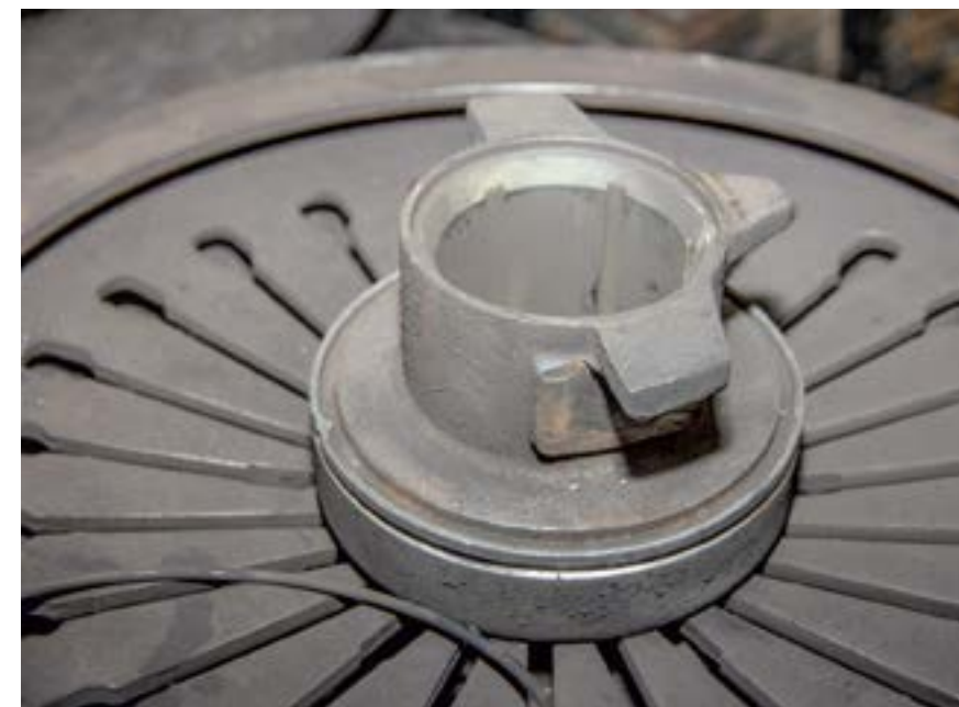
От качества нажимного подшипника во многом зависит ресурс сцепления. Если муфта будет подклинивать, то ускоренный износ лепестков диафрагменной пружины обеспечен. Это грозит отказом всего сцепления
