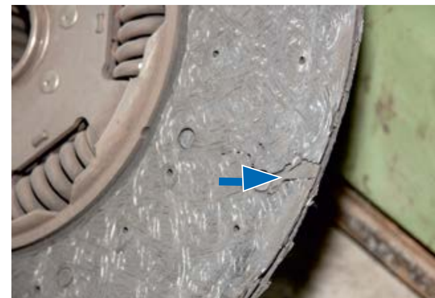
Изношенный до заклепок фрикцион нередко начинает крошиться. Это приводит к сильному и неравномерному износу маховика, что значительно удорожает ремонт
