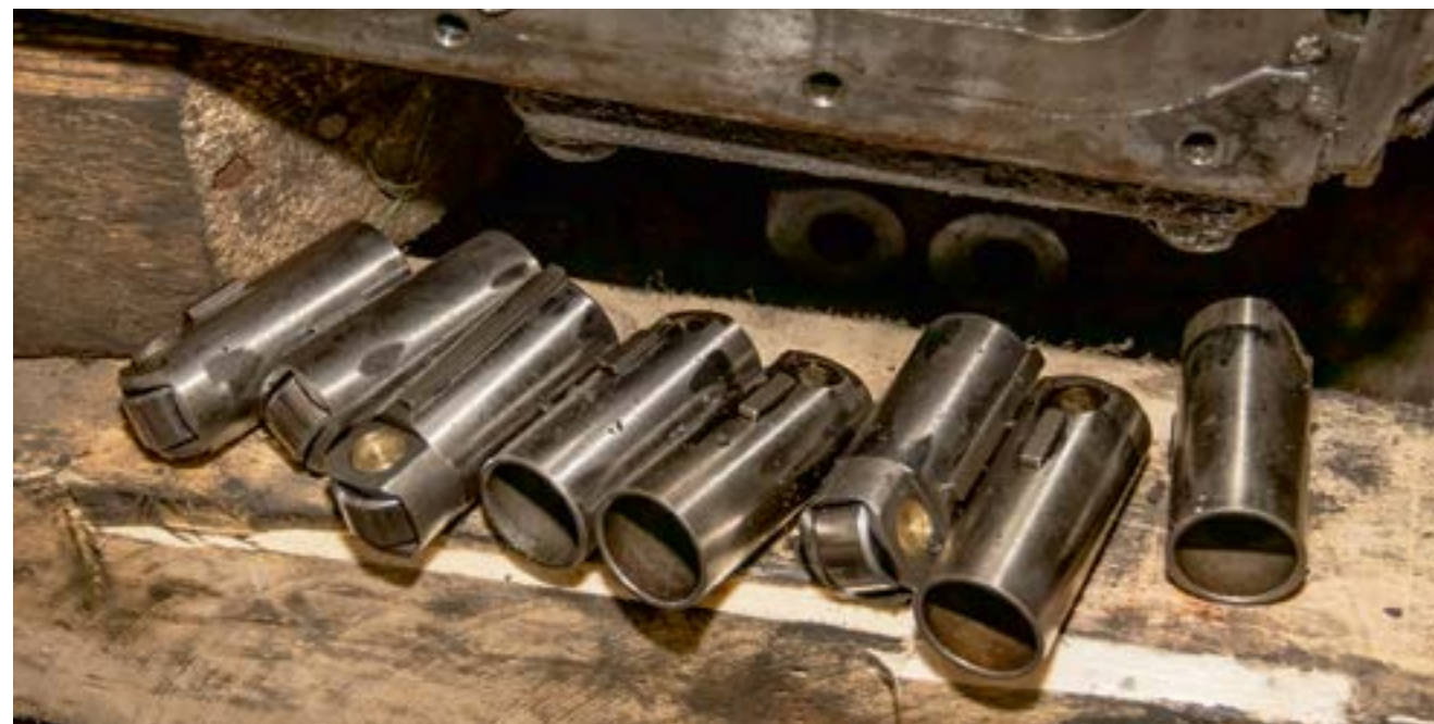
Длинная шпонка выдает ремонтный толкатель
