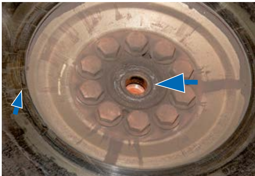
При замене сцепления важно заменить и подшипник, в который входит вал коробки передач. Экономить на этой детали нельзя, так как ее замена требует демонтажа КПП и узла сцепления. Также важно убедиться в отсутствии трещин на маховике
