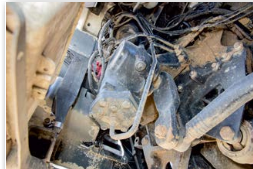
Рулевой редуктор фирмы ZF грузовика MAN TGX. Пробег машины – более 1,5 млн км. На корпусе нет даже следов потекла масла. Это говорит о качестве агрегата и применении при его обслуживании качественных гидравлических жидкостей
