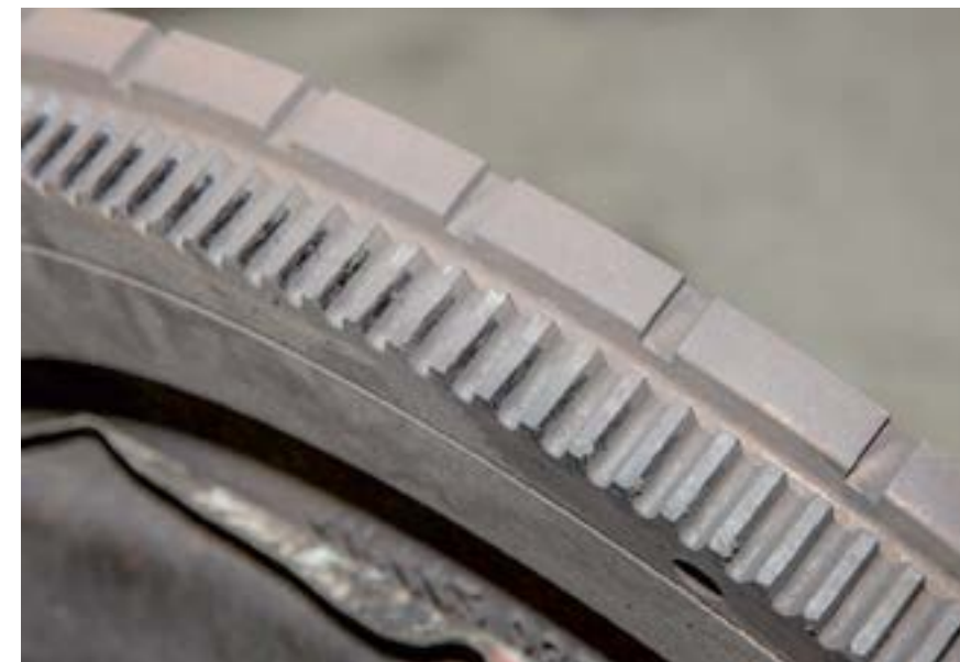
При замене сцепления обязательно проверьте состояние зубьев венца маховика. При их износе венец нужно заменить новым
