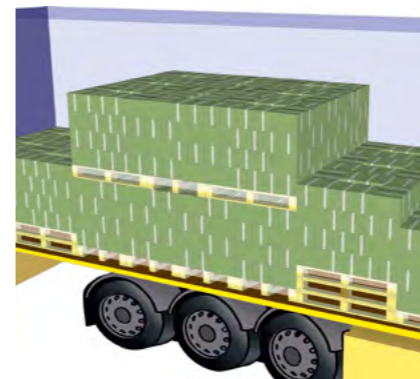
Блокировка верхнего слоя груза за счет уступа в переднем направлении
