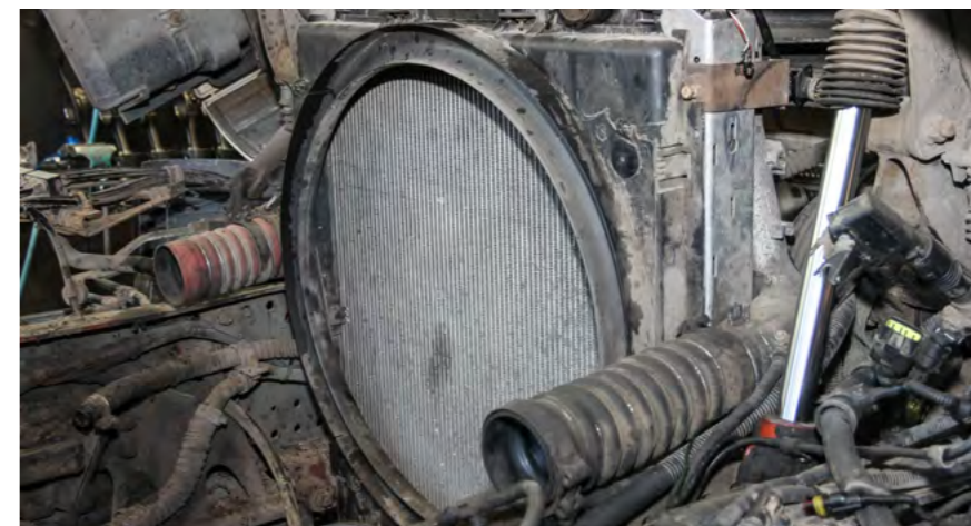
На ресурс моторного масла оказывает влияние эффективность работы системы охлаждения двигателя. Если температура ДВС длительное время будет находиться на верхних значениях или мотор будет работать с перегревом, это приведет к ускоренному износу масла. Срок его службы в данном случае нужно снижать
