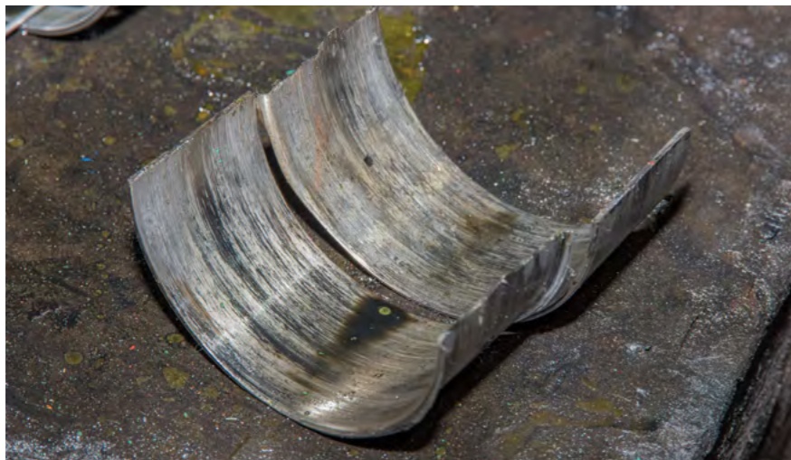
Изменение вязкости сработавшегося масла нарушает условия образования масляного клина в парах шейки коленчатого вала/вкладыши, что приводит к их износу
