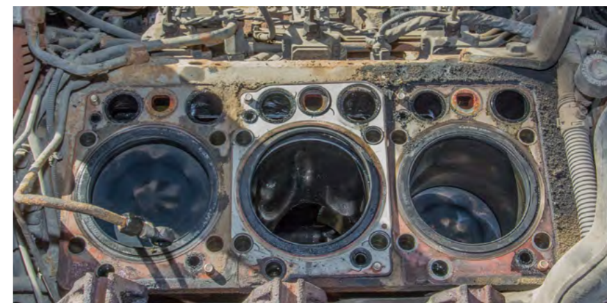
Моторное масло, выработавшее свой ресурс раньше окончания срока проведения ТО, приводит к ускоренному износу цилиндро-поршневой группы. При нынешних ценах на запчасти такой ремонт очень дорог
