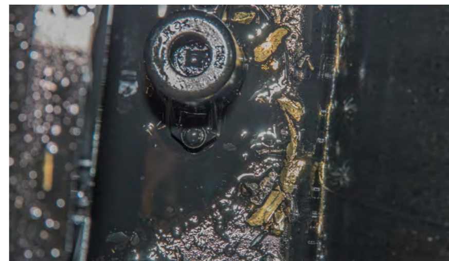
Поддон картера двигателя, масло которого работало максимально возможный из допустимых заводом-производителем интервал. При этом техника эксплуатировалась в сложных условиях. Итог – образование большого количества отложений, ухудшение условий смазки пар трения, аварийное разрушение ДВС. Оптимизация интервала ТО должна была идти в направлении не его увеличения, а уменьшения
