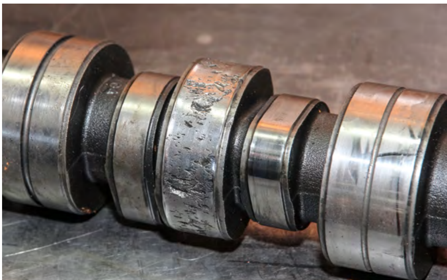
Деградирующее масло не обеспечивает защиту наиболее нагруженных пар трения и контактных поверхностей. Распределительный вал – в группе риска
